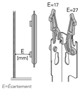
Élément encliqueté avec dispositif de sécurité intégré permettant d'enlever et de déplacer le radiateur ▶ en toute sécurité.
